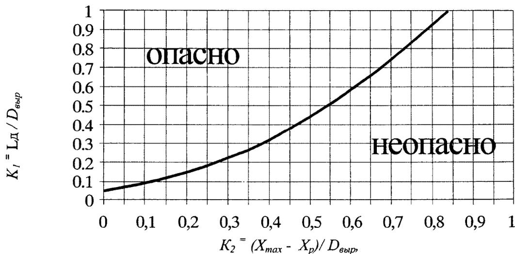
Рисунок 9 - Номограмма для определения категории удароопасности скважин по дискованию керн (для скважин 59 мм; керн 42 мм):  $X_{\max}$  - расстояние от контура выработки до максимума опорного давления, м;
