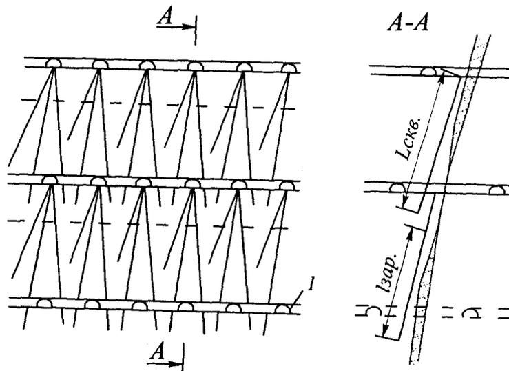
Рисунок 14 - Схема расположения скважин вблизи тектонического нарушения
