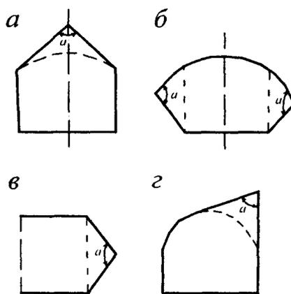
Рисунок 15 - Полигональная форма выработок при расположении мест разрушения: а - в кровле, б - в стенках, в - в забое выработки, г - в сопряжении кровли со стенкой,  $\alpha$  - угол разрушения поперечного сечения
