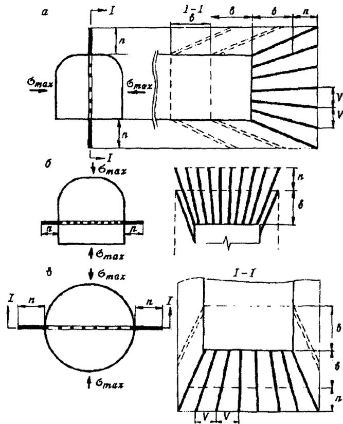
Рисунок 11 - Схемы камуфлетного взрывания по рядам шпуров:
