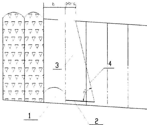
Рисунок 5 - Построение защищенной зоны бурением скважин большого диаметра по кровле (а) и почве (б) рудного тела
